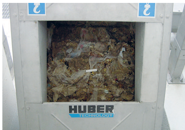
STEP SCREEN® 阶梯格栅的应用: 运转稳定安全, 通过特殊制作的底部台阶可以安全抵抗细砂、石砾和石块, 并可进行平底栅渣运输。
