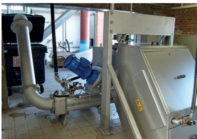
STEP SCREEN® 阶梯格栅和HUBER 栅渣洗涤压榨机SL系列结合使用时, 可在全封闭防臭系统内对栅渣进行强力洗涤处理。
