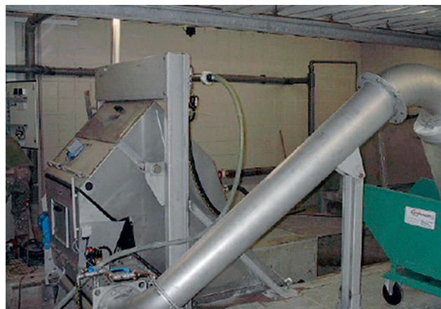
STEP SCREEN® 阶梯格栅配置 HUBER 栅渣洗涤压榨机时可以获得最佳的栅渣分离和脱水效果。机械全不锈钢结构, 并经过浸泡式酸钝化处理, 抗腐蚀性能极强。
