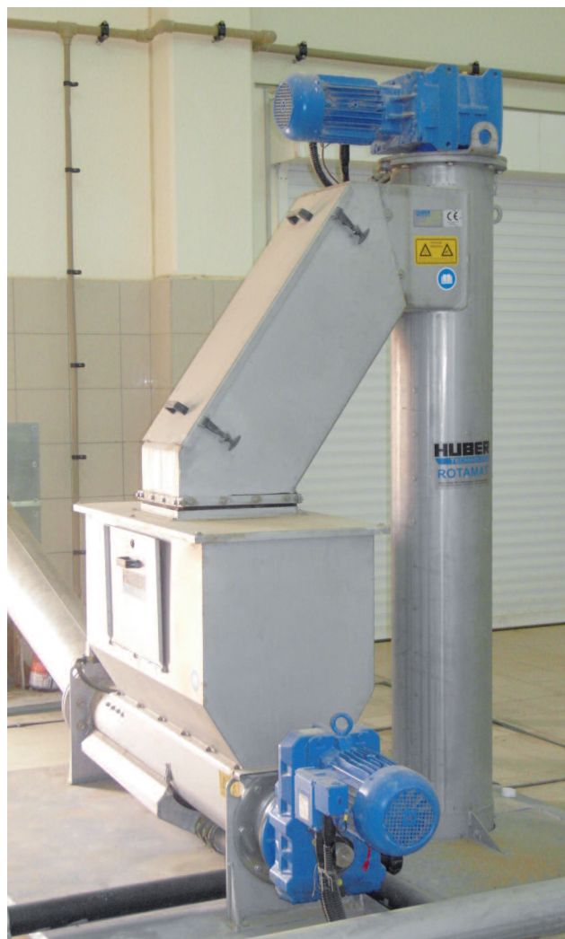
垂直运输螺杆 Ro 8 将栅渣投入到 HUBER 洗涤压榨机。
