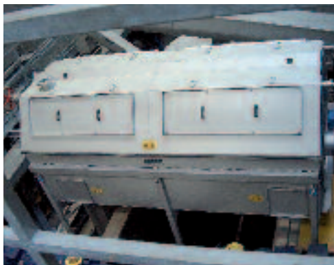
ROTAMAT® RoMesh® 过滤转鼓滤网间隙 : 0,2 bis 1,0 mm
