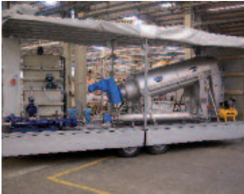
RoS 3Q 螺压机 – 移动型试验机
