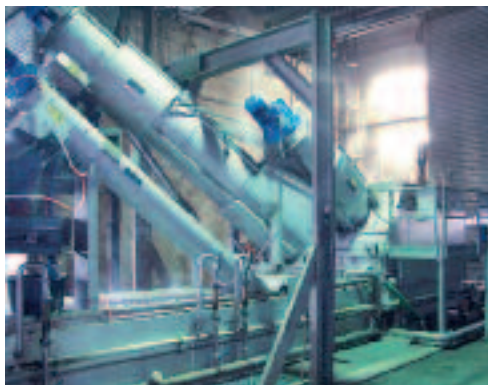
HUBER ROTAMAT® Ro 5 BIO 一体式装置 使用在一垃圾生物垃圾发酵厂
