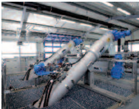
ROTAMAT® RoMem 膜格栅有效清除毛发和纤维物质
