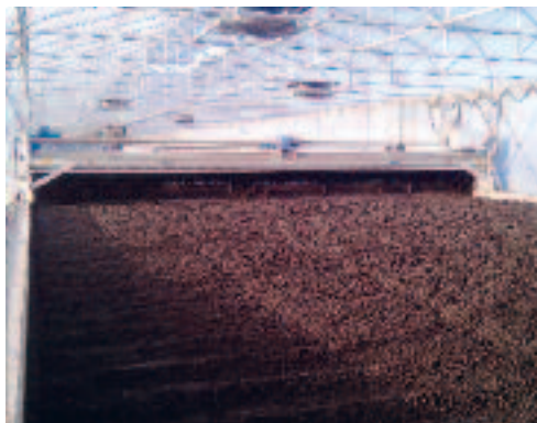
应用SRT太阳能干化装置进行脱水污泥干化
